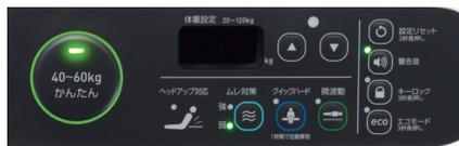
体重40~60kgの方であれば、ワンタッチで自動に内圧調整ができる“かんたんモード”を搭載。自動ヘッドアップ対応機能。
