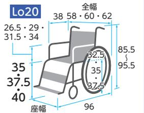
※体型や状況に合わせて選べる3サイズ、押し手高・ひじ高調整機能付 ※前座高・後座高・ひじ高はクッションの厚み含まず
