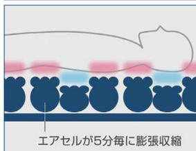
独立したエアセルが膨張収縮を繰り返し、5分毎に身体の保持面が切替わります。これにより常時肌とマットレスが密着せず、不快なムレを軽減します。
