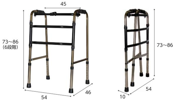
歩幅に合わせて、左右のフレームを交互に動かします。持ち上げる力の弱い方でも操作できます。特に負荷のかかりやすい脚連結部を二重構造にしています。
