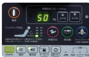
マットレスに内蔵されたセンサがヘッドアップ角度を検知して圧切替を静止し、最適な内圧に自動調整します。角度に応じた内圧調整により、圧迫感や不快感のない頭側挙上を実現できます。自動化により設定や解除のし忘れがないので、底づき防止に安全かつ確実に対応できます。
