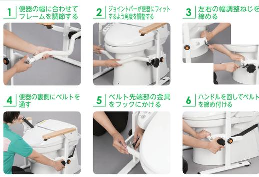
便器の幅に合わせてフレームを調整できるため、あらゆる大きさの便器に対応可能。簡単に設置でき、使用者に優しい手すりです。
